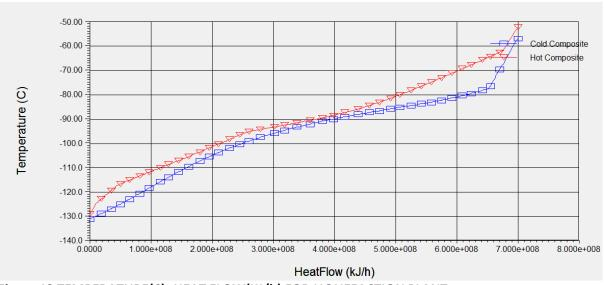
Figure 13 TEMPERATURE(C)- HEAT FLOW(KJ/h) FOR LIQUEFACTION PLANT.
